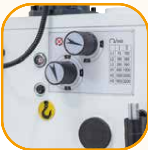
Einfache Bedienung der Schaltelemente für den Drehzahlwechsel.
