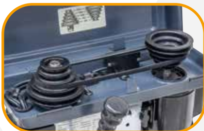
Hohe Laufruhe durch gewuchtete Antriebsscheiben.
