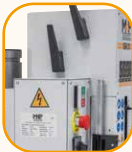
Schnelles und einfaches Einstellen der Drehzahl bzw. der Drehrichtung.
