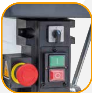
Serienmäßig mit Nockenschalter für Rechts- und Linkslauf
