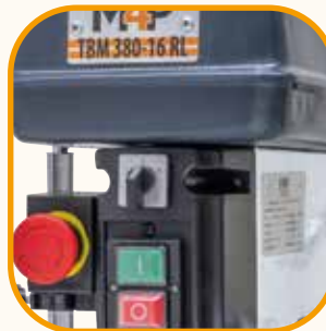
Serienmäßig mit Nockenschalter für Rechts- und Linkslauf (TBM 380 - 16 RL).
