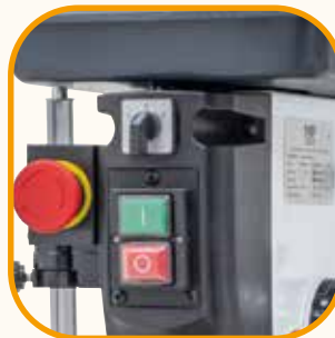
Serienmäßig mit Nockenschalter für Rechts- und Linkslauf (TBM 430 - 16 RL).
