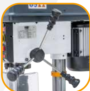
Leichtgängige Pinolenzustellung über ergonomisch angeordnete Handgriffe.
