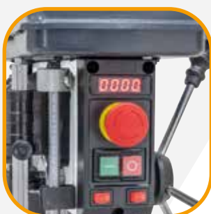
Leichtes Ablesen der eingestellten Drehzahl mittels Digitalanzeige.
