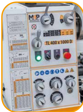
Übersichtlich angebrachte Schaltelemente am Getriebekopf, gehärtete und geschliffene Zahnräder sorgen für einen ruhigen Lauf.
