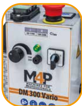
Die Spindeldrehzahl ist stufenlos einstellbar, serienmäßig mit Rechts-Linkslauf ausgestattet.
