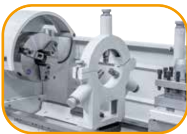
Serienmäßig mit feststehender Lünette zum Einspannen von langen Werkstücken.
