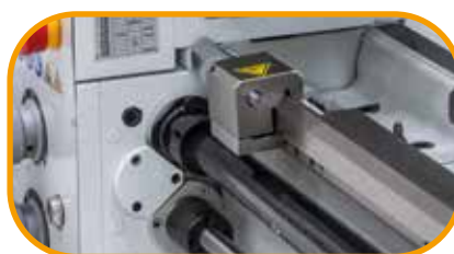
Mikrometerlängsanschlag und Rutschkupplung im Lieferumfang enthalten.
