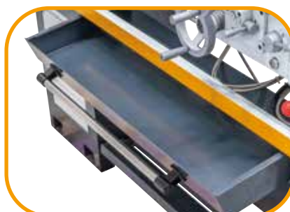
Serienmäßig mit ausziehbarer Spänwanne
