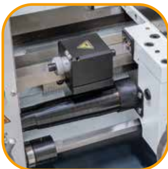
Mikrometerlängsanschlag und Rutschkupplung im Lieferumfang enthalten.
