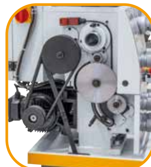
Lieferumfang komplett mit Wechselrädern zum Gewindeschneiden.
