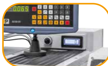
Elektronisch, stufenlose Drehzahlregelung, leichtes Ablesen mittels Digitalanzeige.
