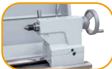
Reitstock mit MK 4 Aufnahme kann zum Kegeldrehen verstellt werden
