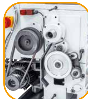
Lieferumfang komplett mit Wechselrädern zum Gewindeschneiden.
