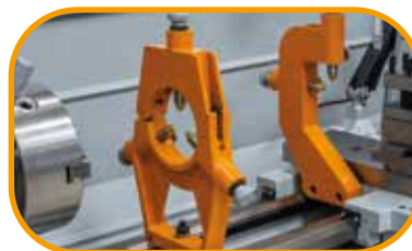
Zum Stabilisieren von langen Werkstücken serienmäßig mit einer feststehenden bzw. mitlaufenden Lünette ausgestattet.
