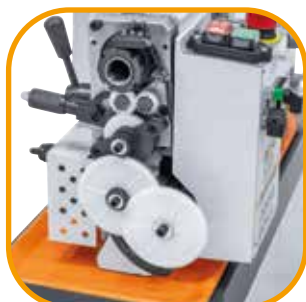
Wechselräder zum Gewindeschneiden im Lieferumfang enthalten.
