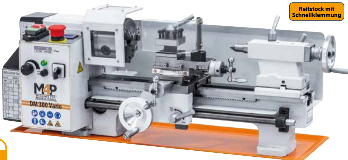
Reitstock mit MK 2 Aufnahme kann zum Kegeldrehen verstellt werden
