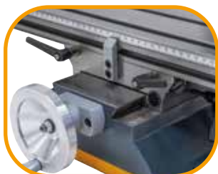
Schwalbenschwanzführung für x-, y- und z-Achse, nachstellbar über Keilleisten.
