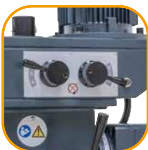
Einfache Bedienung der Schaltelemente für den Drehzahlwechsel
