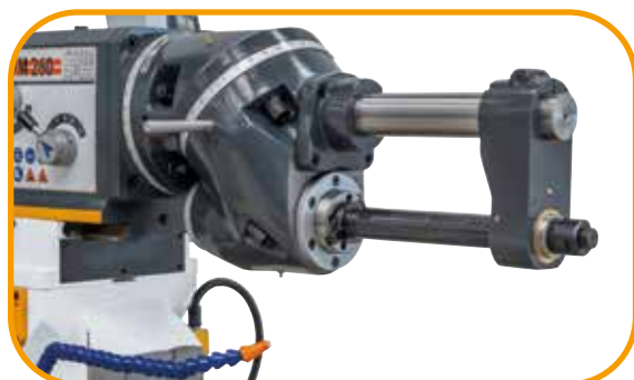
Zum Fräsen in horizontaler Position serienmäßig mit Gegenlager und langem Fräsdorn.
