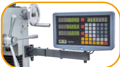
Digitalanzeige M4P SDS6-3V in x-, y- und z-Achse ist im Lieferumfang enthalten (Art. Nr. 1007036).
