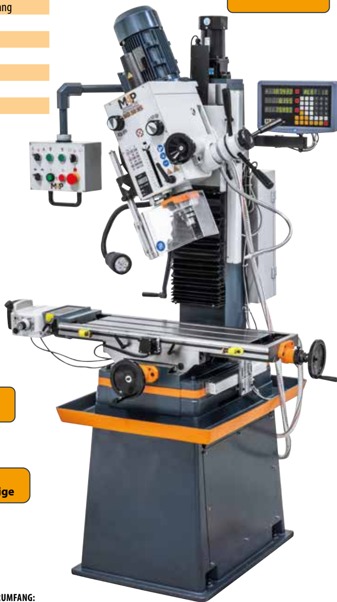
Durch die digitale Positionsanzeige in 3 Achsen wird eine Produktivitätssteigerung bis zu 50% erzielt.
