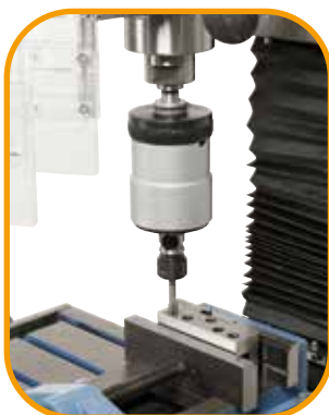
Zum Gewindeschneiden kann die Maschine mit einem Gewindeschneidapparat von M5 - M12 ausgerüstet werden.
