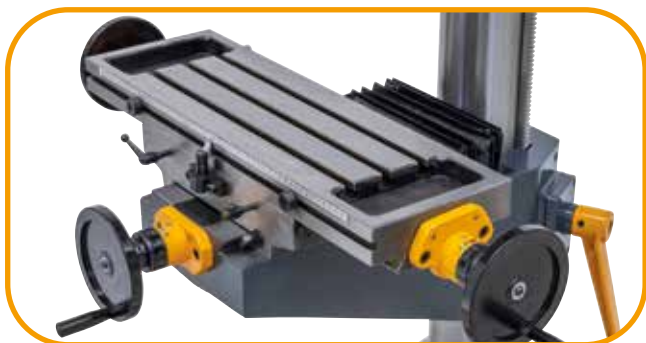
■ Großdimensionierter Kreuztisch mit T-Nuten und Kühlmittelrinne.
