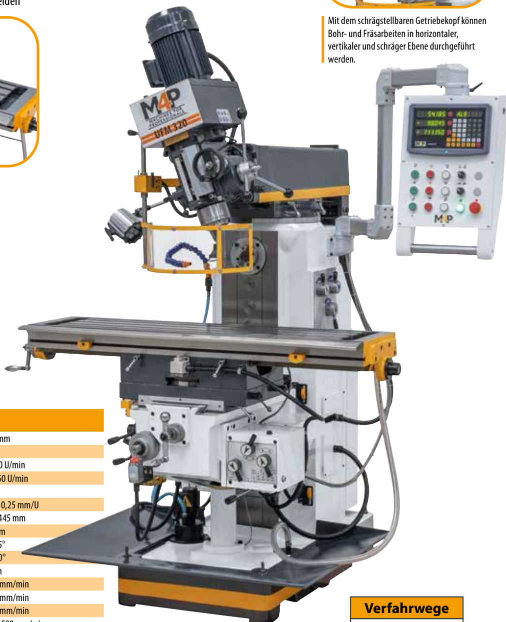
Frästisch mit T-Nuten und Kühlmittelrinne, schwenkbar von -45° bis +45°
