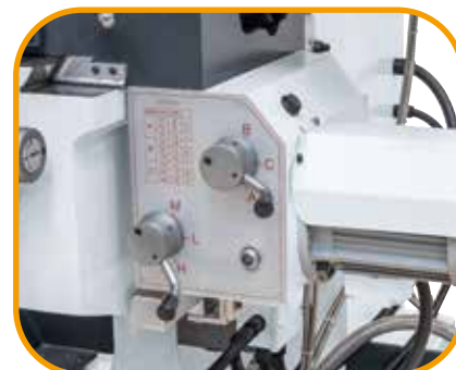
Serienmäßig mit 9-stufigem Vorschub in x- und y-Achse.
