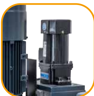
Fräskopfhöhenverstellung serienmäßig mit Hubmotor
