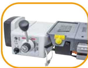
Serienmäßig mit stufenlosem Frästisch- vorschub in x-Achse mit Eilgang
