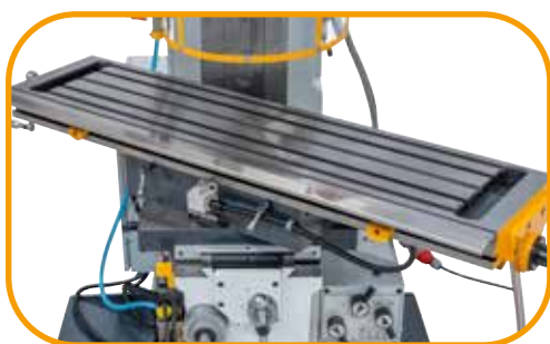
Frästisch mit T-Nuten und Kühlmittelrinne, schwenkbar von -45° bis +45°
