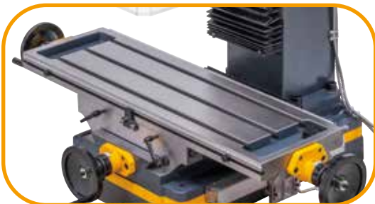
Großdimensionierter Kreuztisch mit T-Nuten und Kühlmittelrinne.
