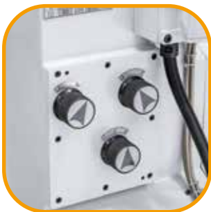
Serienmäßig mit bedienerfreundlicher Getriebeschaltung für die Horizontalspindel.
