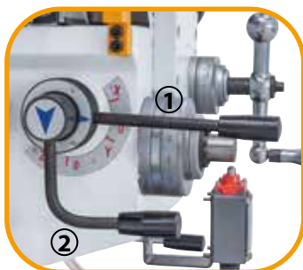
1: Vorschubhebel für x- und y-Achse 2: Vorschubhebel für z-Achse
