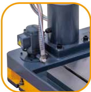
Leistungsstarke Kühlmittelpumpe im Lieferumfang enthalten.
