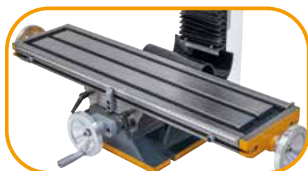
Präzise oberflächenbearbeiteter Kreuztisch mit 3 T-Nuten.
