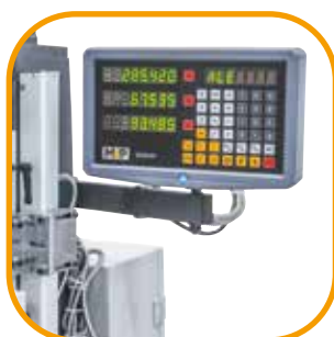
Durch die digitale Positionsanzeige in 3 Achsen wird eine Produktivitätssteigerung bis zu 50% erzielt.
