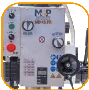
Digitale Pinolenvorschubanzeige für komfortables Arbeiten.
