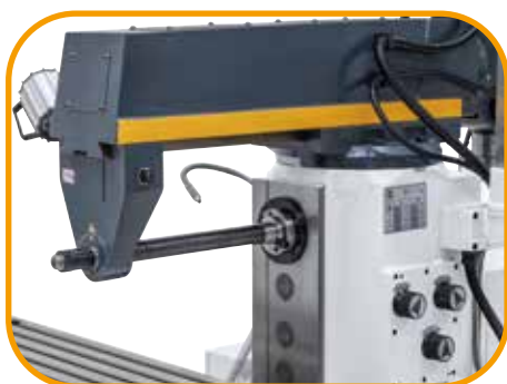
Zum Fräsen in horizontaler Position serienmäßig mit Gegenlager und langem Fräsdorn.
