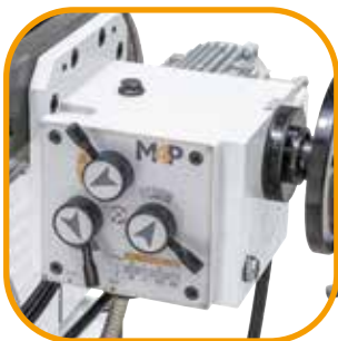
Tischlängsvorschub mit Eilgangsfunktion serienmäßig im Lieferumfang enthalten
