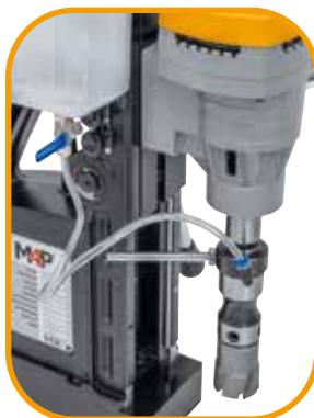
Automatische Innenschmierung, das Kühlmittel wird direkt an die Spitze des Kernbohrers geleitet
