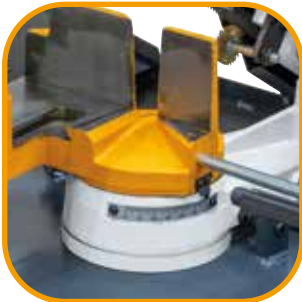
Schwenkbarer Sägebügel für Gehrungsschnitte bis 60°
