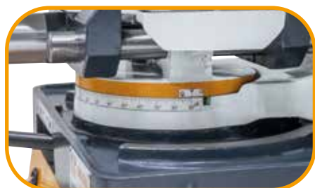
Getriebekopf nach rechts und links 90° schwenkbar
