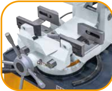
Zentrisch spannender Schraubstock mit längsverschiebbaren Spannbacken.
