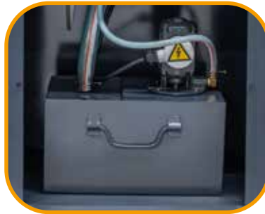
Leistungsstarke Kühlmiteleinrichtung, platzsparend im Untergestell integriert.
