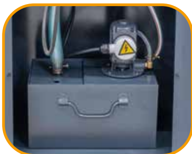
Leistungsstarke Kühlmiteleinrichtung, platzsparend im Untergestell integriert.
