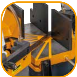
Schnellspannschraubstock zum Doppelgehrungsschneiden verschiebbar.
