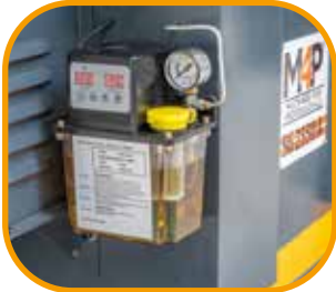
Automatische Zentralschmierung für alle Führungsbahnen und Spindeln.
